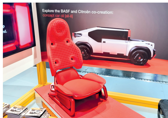
Bild 5. Die Fahrzeugstudie Oli von Citroën und BASF soll zeigen, wie Elektroautos künftig nachhaltiger und erschwinglicher werden können. Um die Recyclingfähigkeit zu verbessern, besteht etwa der Sitz komplett aus einem Monomaterial.
