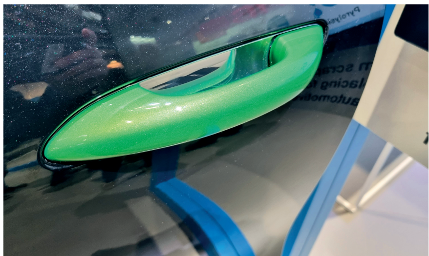
Bild 7. Reifen zu Türgriffen – das für das Bauteil der Mercedes Benz S-Klasse verwendete PA6 wird unter anderem aus Pyrolyseöl aus chemisch recycelten Altreifen hergestellt. © Hanser/F. Streifinger
