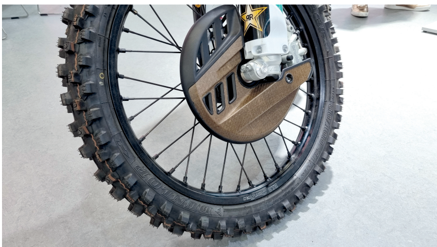
Bild 2. Spannend bei dem Bremsscheibenschutz ist sowohl das Produktionsverfahren als auch das verwendete Material: Das genutzte Fügeverfahren ermöglicht die stoffschlüssige Verbindung von Duro- und Thermoplasten. Bei dem verwendeten Thermoplast handelt es sich um ein biobasiertes PA von Akro-Plastic. © Hanser/F. Streifinger
