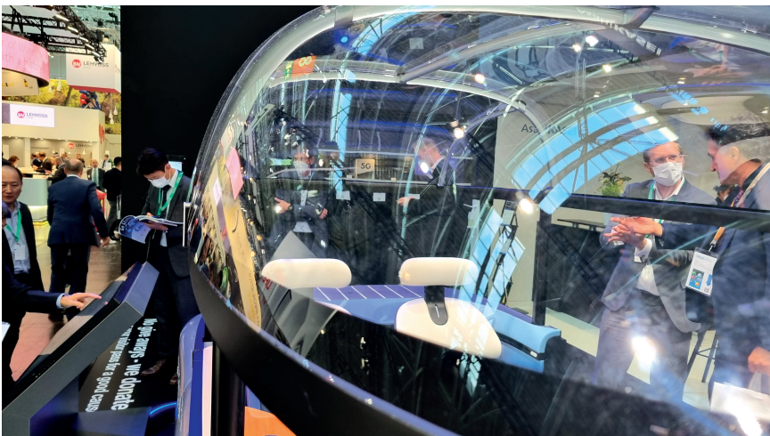
Bild 4. Die Haube des Konzeptfahrzeugs von Asahi Kasei besteht aus PC. Die dafür entwickelte Beschichtung erhöht die Kratzfestigkeit und Beständigkeit, wodurch das Polymer die für Windschutzscheiben notwendigen Anforderungen erfüllt. © Hanser/F. Streifinger
