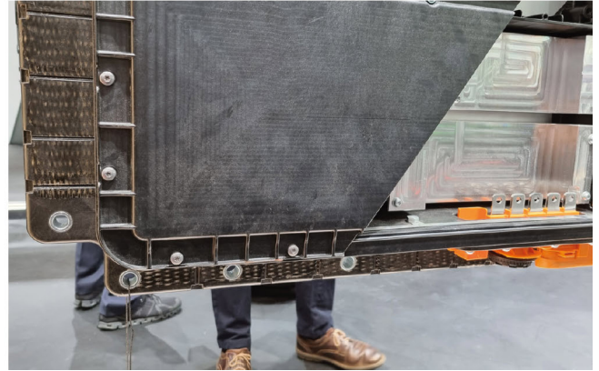
Bild 3. Der Batteriedemonstrator ist an den Akku des ID.3 angelehnt. Das Gehäuse wurde in einem einstufigen Prozess komplett aus Kunststoff gefertigt. Zum Schutz wurde es an verschiedenen Stellen mit einem endlosfaserverstärkten Composite verstärkt. © Hanser/F. Streifinger
